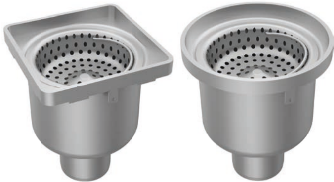
DRS-S / DRSK-S Geruchsverschluss bestehend aus Glocke und eingeschweißtem Standrohr, ohne Dichtung (wartungsfrei), mit Schlammfang
