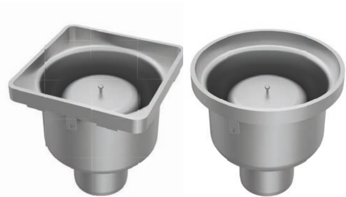
DR-S Geruchverschluss bestehend aus Glocke mit eingeschweißtem Standrohr, ohne Dichtung (wartungsfrei), ohne Schlammfang
