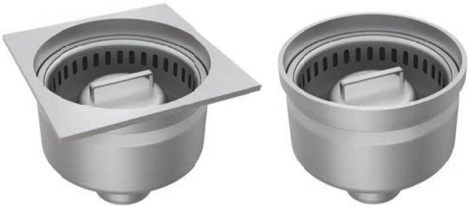
71-S Großer kombinierter Schlammfang, mit Geruchverschluss, bestehend aus Glocke und eingeschweißtem Standrohr, ohne Dichtung (wartungsfrei)
