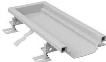
GKRH Als Kantenschutz 2 Stück Edelstahl-Rechteckrohr, sowie Maueranker im Abstand von 500 mm.
